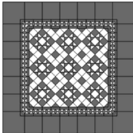
4. Posez la bordure de périmètre en utilisant l'élément de remplissage de 8 1/2" (215,9mm), à condition que les joints de la bordure soient alignés sur la bordure Diamond et les joints des dalles de sol.
