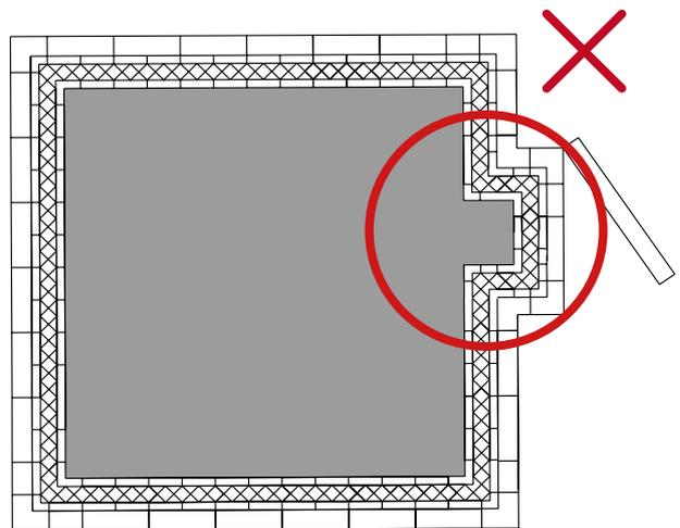
Lors de la préparation de la surface sur laquelle le sol doit être posé à un angle de 45°, utilisez deux bords droits ou lames positionné(e)s à 90° comme point de départ. Ceci permet un meilleur alignement initial.
