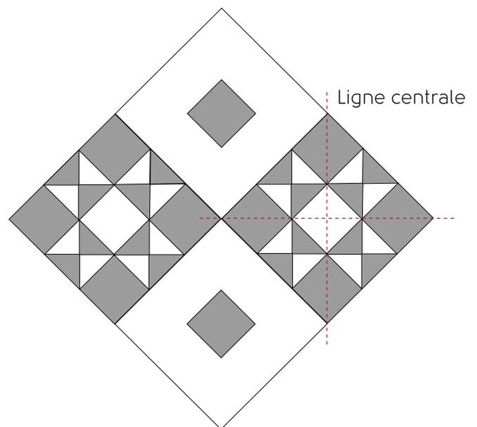
2. Posez les dalles de sol principales, sans oublier de prévoir un espace adéquat pour la bordure et l'élément de remplissage si nécessaire. Passez ensuite à la pose des dalles de bordure, de coin et de remplissage.
