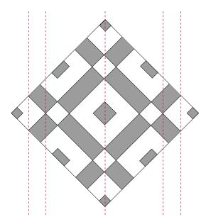
Vous trouverez ci-dessous un exemple d'agencement de sol. Remarque : les segments des bordures pour cet agencement ne sont pas alignés sur les dalles de sol, mais il est recommandé de découper les dalles de surface uniquement au point de contact de chaque diamant avec la dalle de surface. Ainsi, la bordure reste toujours perpendiculaire aux dalles de surface et donne un aspect harmonieux au sol dans son ensemble.
